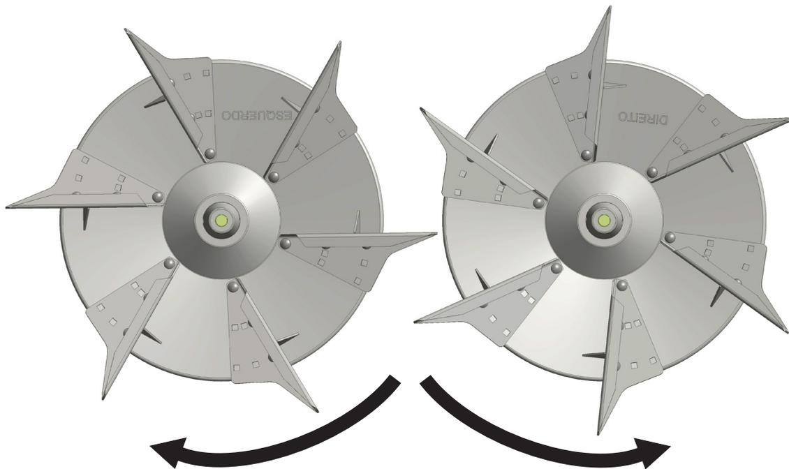
Os discos de distribuição devem ser fixados na caixa tripla através de parafusos e arruelas, tomando cuidado para encaixar os canais dos discos às chavetas.
